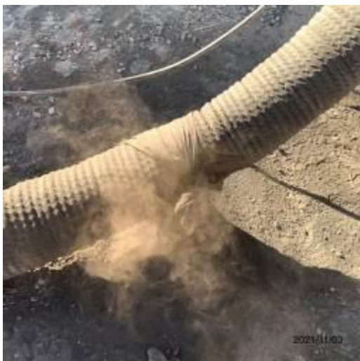
Фото 63 и 64. Лот 2. Выбросы с поврежденных участков на соединительных шлангах.
