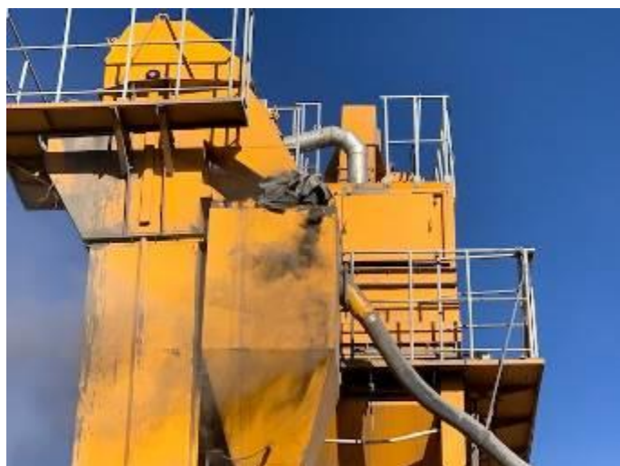
Фото 63 и 64. Лот 2. Выбросы с поврежденных участков на соединительных шлангах.
